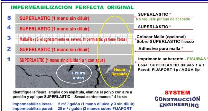
Identifique la fisura, amplie con espátula, elimine el polvo con aire a presión y aplique SUPERLASTIC – Secado entre manos \* 4 horas
